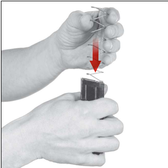
Figure 44 — Vstavite prinašalo z vzmetjo v ohišje nabojnika
