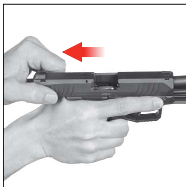
Slika 14 Zaklep povlecite do konca nazaj in ga izpustite
