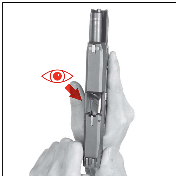
Slika 7 — preglejte ležišče in odprtino za nabojnik: ni nabojev/ nabojnika
