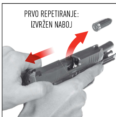
Slika 21 Energično repetirajte prvič: opazujte, če je izvržen naboj
