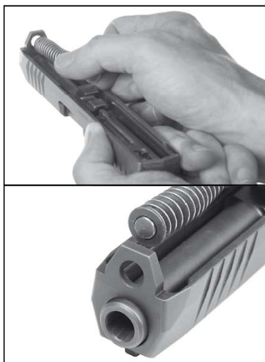
Figure 39 Vstavite stopničasti del vodila povratne vzmeti v sprednji del zaklepa
