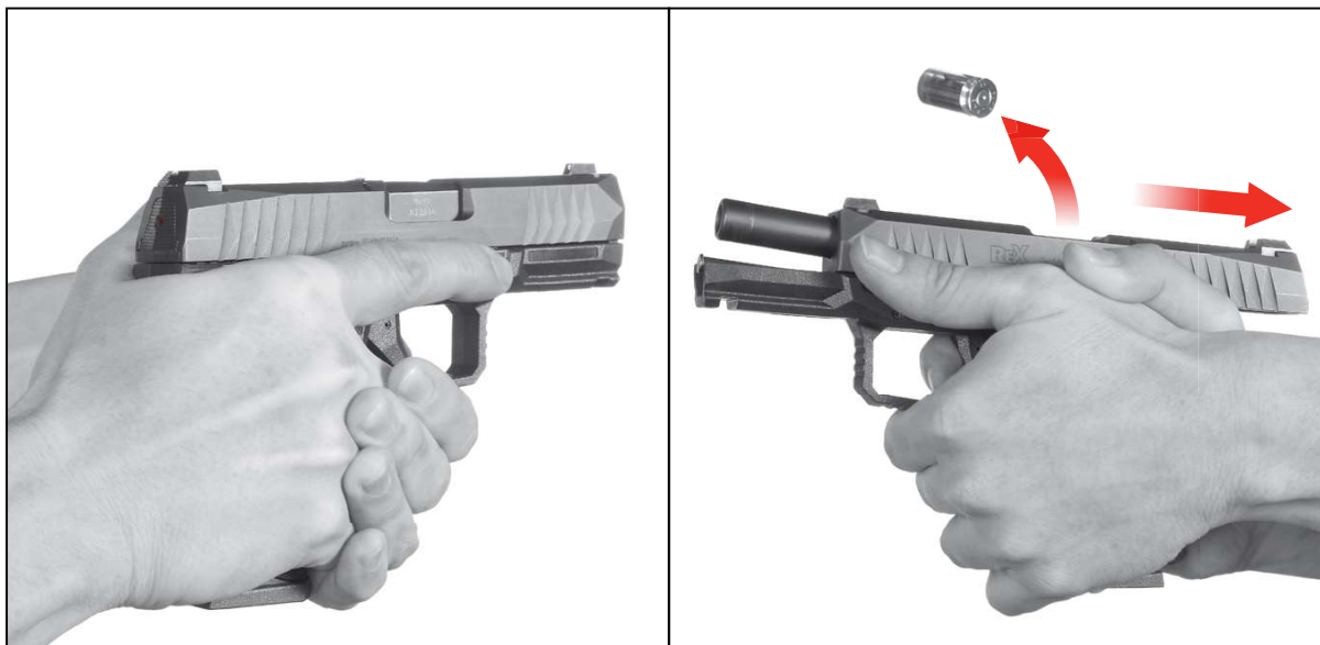
Slika 18 — Dvoročni oprijem pištrole / Pozor: zaklep se giblje nazaj (dve fotki)
