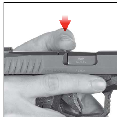
Slika 15 Preverjanje položaja pokazatelja polnega ležišča s tipanjem
