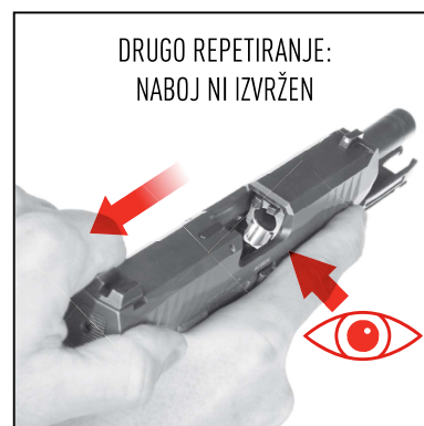
Slika 22 DRUGIČ odprite zaklep in držite odprtega: preverite, da je ležišče prazno
