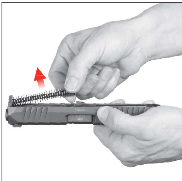
Slika 26 — Vodilo z ujeto povratno vzmetjo vzemite iz zaklepa.
