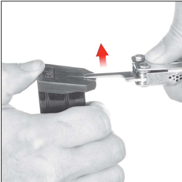
Slika 28 — S ploščatim orodjem rahlo privzdignite utrjevalno dno nabojnika
