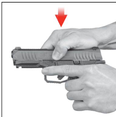
Figure 42 Zaklep postavite na ogrodje (zaklep je bolj naprej, kot v zaprtem položaju)
