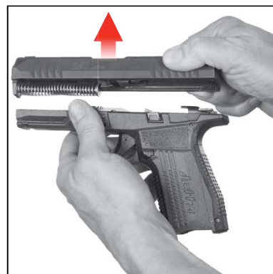
Slika 25 Zaklep dvignite in snemite z ogrodja
