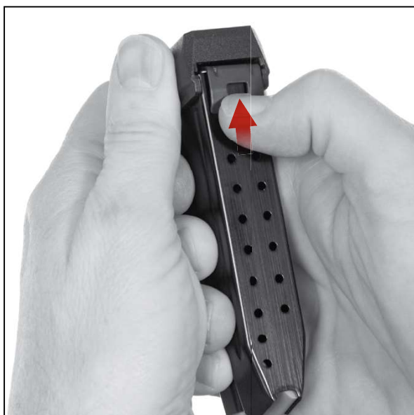
Slika 32 — Utrjevalno ploščico s palcem premaknite navzdol in jo zadržite
