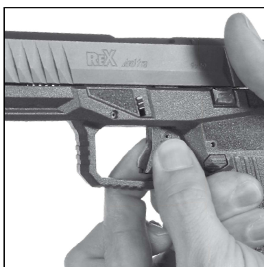
Figure 51 Preverjanje jezička sprožilca - sprožilec se kljub pritisku ne bi smel premakniti nazaj, če jeziček ni pritisnjen
